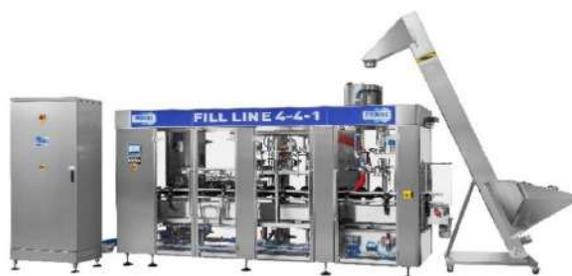
L'appareil comprend également une première section de vis sans fin, s'étendant dans la section de remplissage et actionnée par des premiers éléments de motorisation, et une seconde section de vis sans fin, s'étendant entre l'extrémité de la section de remplissage et la section de bouchage, et actionnée par des seconds éléments de motorisation indépendants des premiers.
